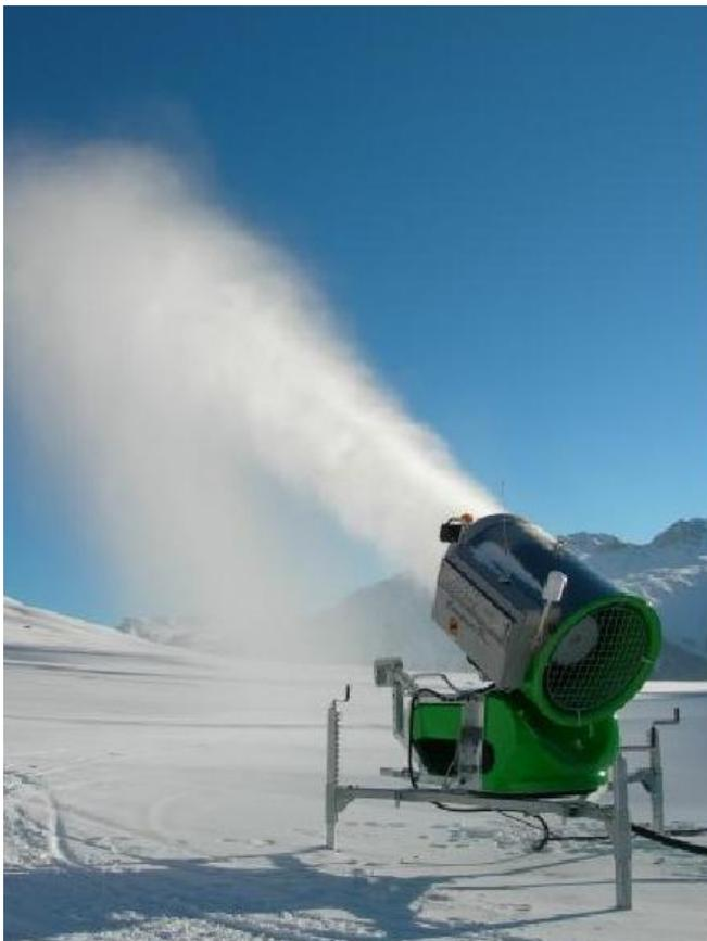
Abbildung 19: Propellermaschine im Einsatz
